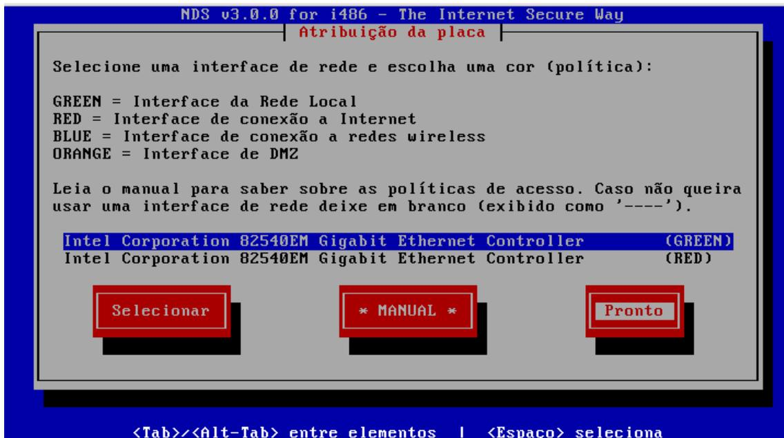
Em seguida, aparece a tela de configuração de ip da interface de rede GREEN, defina o IP e máscara de rede de sua rede interna.
